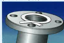
ピラーNo.3300 使用例 (フランジガスケット)
